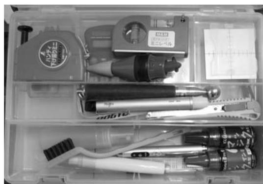
写真-2 現況調査に使用する機材の例
