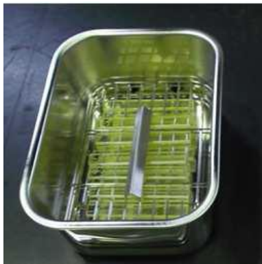
解写真 1 試験片の浸漬状況例[1]
