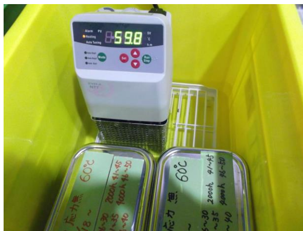
解写真 2 温度の管理状況例[1]
